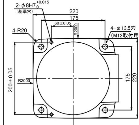
注1: 図の寸法は、10kg可搬用 (HM-4\*\*\*-UL) を基準に記載しており、ツール取付面・フランジ取付図の ( ) 内の寸法は、20kg可搬用 (HM-4A\*\*\*-UL) を示します。
